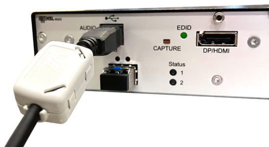
Abb. 11 Ferrit korrekt angebracht
