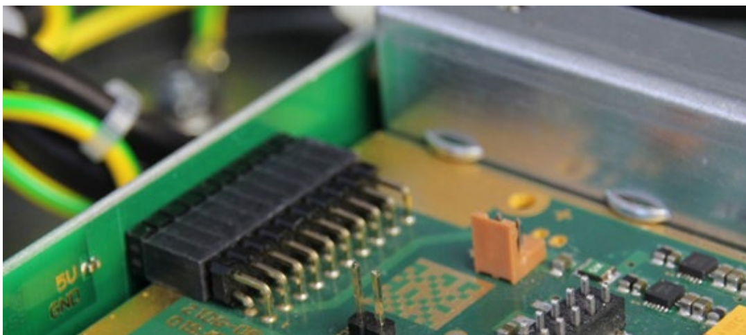
Abb. 60 Zusatzmodul eingebaut in einem 2-/6-Slot-Einschub-Chassis
