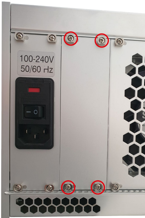
Abb. 81 Leerblende am Chassis 474-BODY21/4U demontieren
