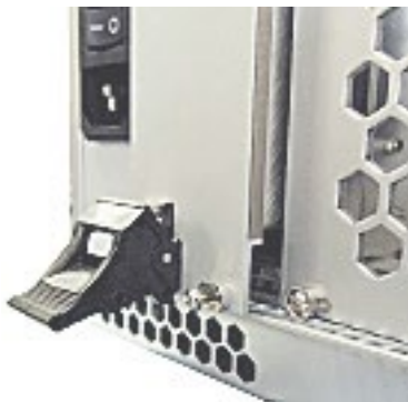
Abb. 82 Ausziehhebel am Netzteil für Chassis 474-BODY21/4U
