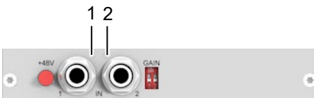
Abb. 39 Anschlussseite Zusatzmodul symmetrisches Audio - Status-LEDs L-/R474-BBX
