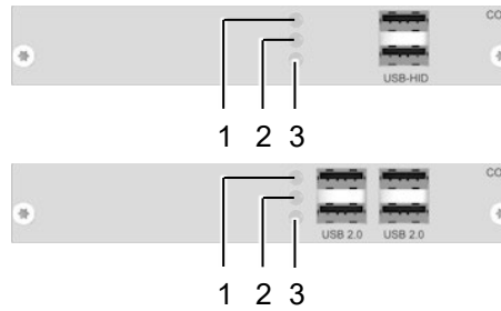
Abb. 51 Anschlussseite Zusatzmodul USB 2.0 embedded - Fehleranzeige
