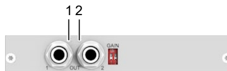
Abb. 39 Anschlussseite Zusatzmodul symmetrisches Audio - Status-LEDs L-/R474-BBX
