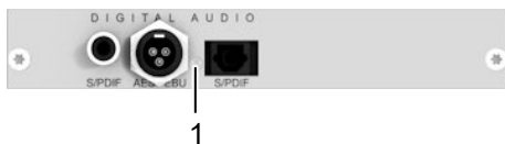
Abb. 49 Anschlussseite Zusatzmodul Digital-Audio - Fehleranzeige
