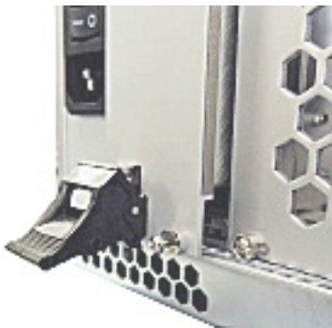
Abb. 82 Ausziehhebel am Netzteil für Chassis 474-BODY21/4U
