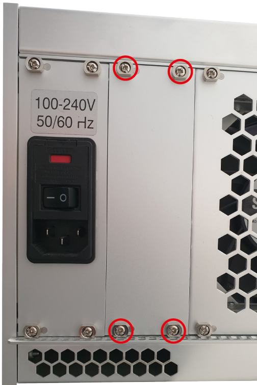
Abb. 81 Leerblende am Chassis 474-BODY21/4U demontieren
